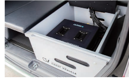
ヒート機能付リン酸鉄リチウムイオンバッテリー(写真は500Ah)
