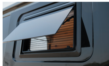
左右RVウインドウ (網戸・シェード体型のアクリル二重窓)
