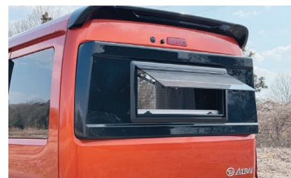
リヤRVウインドウ (網戸・シェード体型のアクリル二重窓)
